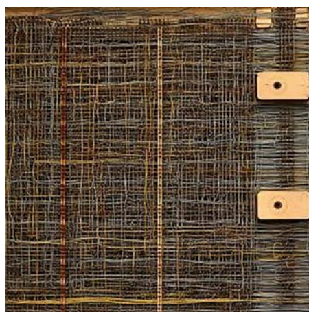
Rysunek 3. Pamięć ferrytowa, tworzona przez włóknarki, znane jako LOL
