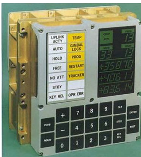
Rysunek 2. Moduł DSKY – interfejs do współpracy z komputerem
