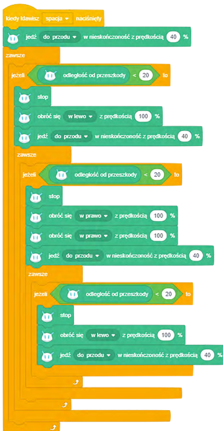
Rysunek 13. Przykładowy skrypt wykonany z uczniami, dzięki któremu robot wykrywa ściany w labiryncie
